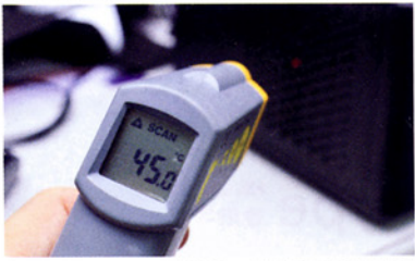
在執行《Battlefield V》遊戲時，以紅外線溫度計量度側板的最熱位置，錄得約 45°C，溫度不算高。
