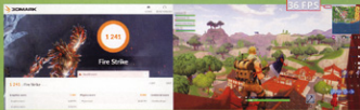
3DMark® Fire Strike 測試得分為 1,241，分數只有 GeForce GTX 1050 Ti 電腦的 25% 水平。
