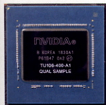
RTX 2070 核心晶片, 編號 TU106-400A1, 12nm 製程及整合 106 億顆電晶體。
