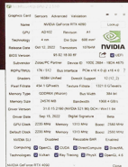
● GPU-Z 2.50.0 版本顯示，Boost 時脈提升到 2,580MHz，較公版高出 60MHz。
