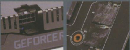
●RTX 2060 (12GB)功耗不高，各廠均採用單8-pin PCI-E Power Connector設計。
