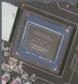
●採用TU106-300-KA-A1，編制上似乎在RTX 2060 (6GB)的TU106-200-KA-A1及RTX 2060 SUPER的TU106-410-A1核心之間。
