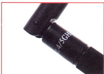
採用外置式天線，支援 2.4 及 5GHz WiFi 網。因為採用外置式 SSD，效能測試得分相當高。
