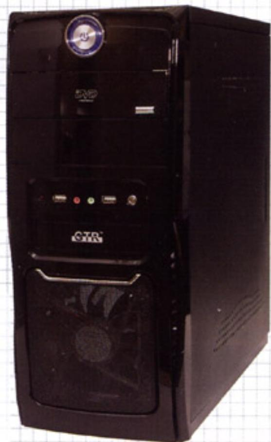
少高階遊戲機箱定價都超過 \$500，才會為用家提供透明側板，而這款 GTR 3071 就以入門級價格為用家提供透明側板。3071 在設計上以入門級 DIY 玩家為主，機內提供兩個 5.25 吋安裝位，而且硬碟位置亦有 4 個，已經足夠一般用家需要。主機板部分支援 ATX 規格，雖然機身較細，但仍然提供前置的 12cm 風扇，用家亦可另購雙 8cm 風扇，分別裝到側板及背部。而側板風扇的位置更可直接為顯示卡提供冷空氣，解決入門級機箱顯示卡散熱能力較低的問題。比較可惜的是前置接口只有兩個 USB 2.0 接口，以及 HD Audio 功能，對於想要配合 USB 3.0 裝置的用家來說，就要另外配合延長線使用。值得一提的是機箱按鍵改為機箱頂部，同樣是入門級機箱較少見的設計，如果你喜歡自行 DIY 機箱，又想得到中階功能之餘盡量減少預算，GTR 3071 是個好選擇。
